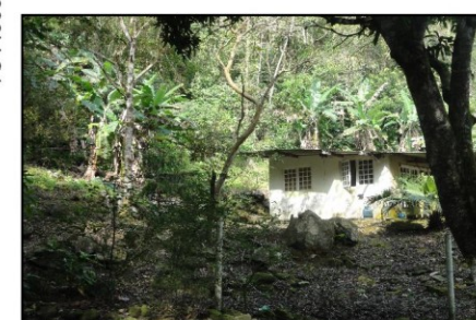
Outra moradia situada sobre depósito de tálus, na base da encosta natural. Notar a presença de blocos no local.
